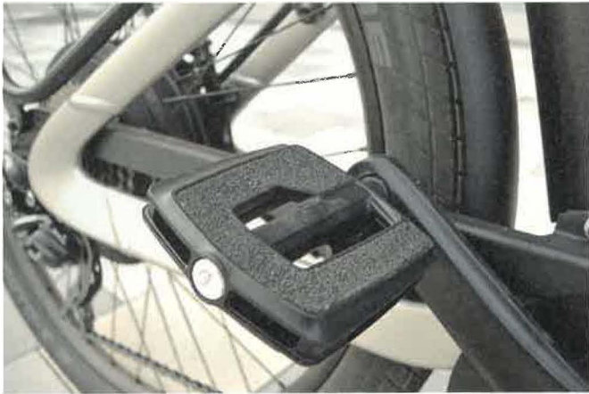
Sicherer Antritt: Die Plattform-Pedale mit aufgerauter Standfläche sorgen für Rutschfestigkeit auch bei Nässe.
