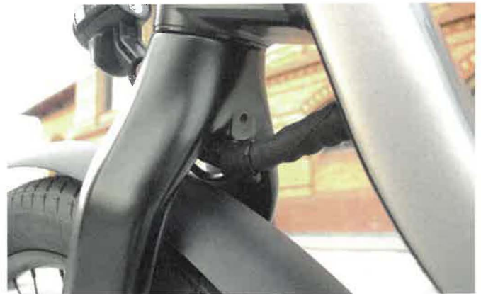
Maximale Integration, flächige Optik: Nur zwischen Gabel und Rahmenunterzug taucht der Kabelbaum einmal kurzzeitig auf.
