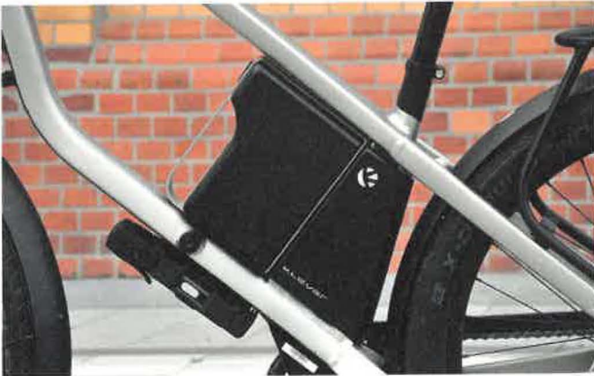
Das Beauty-Case: Der 360-Wh-Akku sitzt zwischen Ober- und Unterzug und ist dank integriertem Griff einfach zu handhaben.
