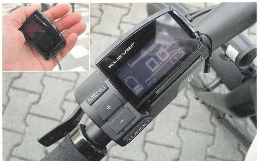
Commuter-Key: Das smarte Lenkerdisplay lässt sich mit einem Handgriff rasch abnehmen. Damit ist das E-Bike gesichert und der elektrische Antrieb für Langfinger blockiert.
