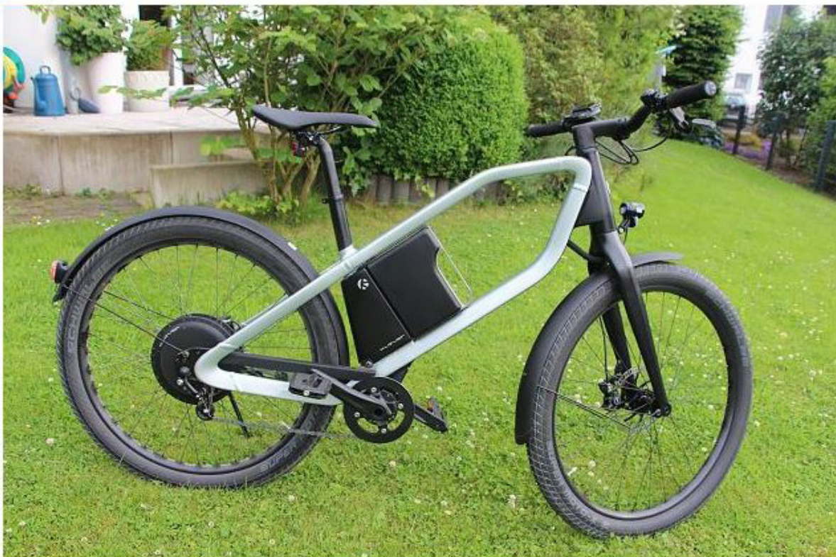
Schon die Rahmenform ist besonders. Wie eine rautenförmige Schleife zieht sich das Aluminiumgerippe vom Steuerrohr bis zur Achse der Hinterradnabe
