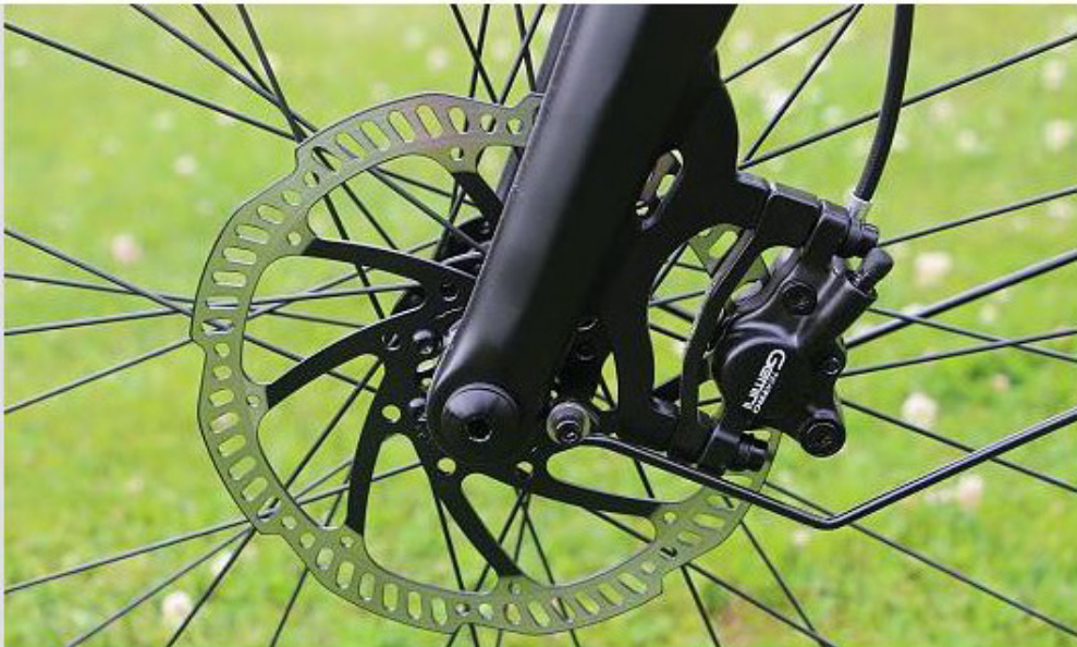
Gebremst wird mit hydraulischen Scheibenbremsen (Tektro Gemini), die für gute Verzögerung sorgen
