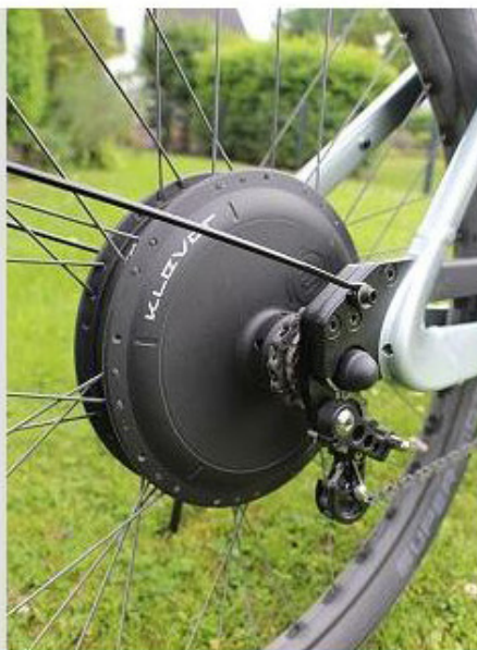
Für einen hammerharten Antritt sorgt der extrem leise laufende Hinterradnabenmotor mit einer maximalen Leistung von 250 Watt
