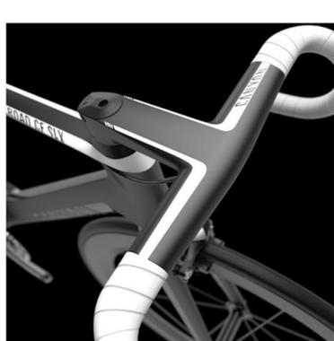
Das Cockpit besteht aus einem Carbon-Monocoque-Element.
