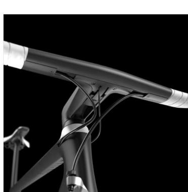
Das speziell entwickelte Cockpit mit integrierter Zugführung. Die typisch tiefe Cockpitposition sowie die maximale, gestalterisch gelungene Systemintegration möglichst vieler Anbauteile wie Cockpit, Sattelstütze und Bremsen runden die auf Aerodynamik hin optimierte Bauweise des Aeroad CF SLX ab.
